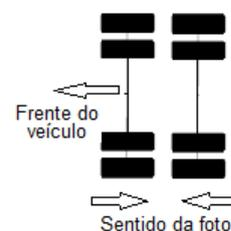
b. Quando o veículo tiver número ímpar de eixos, em tandem ou não: a foto do primeiro eixo – o mais próximo do para-choque – deverá ser tirada no sentido da dianteira do veículo, a foto do eixo intermediário deverá ser tirada no sentido contrário à do primeiro eixo, a foto do eixo mais interno – o mais afastado do para-choque – será no sentido da traseira do veículo e a foto dos demais eixos, de forma alternada, em direção oposta à do eixo anterior, vide figura ao lado.
