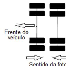
b. Quando o veículo tiver número ímpar de eixos, em tandem ou não: a foto do primeiro eixo – o mais próximo do pára-choque – deverá ser tirada no sentido da dianteira do veículo, a foto do eixo intermediário deverá ser tirada no sentido contrário à do primeiro eixo, a foto do eixo mais interno – o mais afastado do pára-choque – será no sentido da traseira do veículo e a foto dos demais eixos, de forma alternada, em direção oposta à do eixo anterior, vide figura ao lado.
