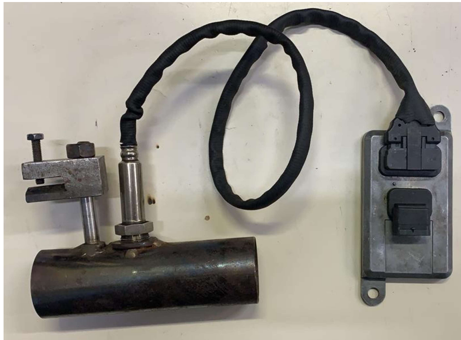
Figura 1 – Adaptador do sensor de \text{NO}_x para ser inserido na ponteira do escapamento do veículo avaliado.
