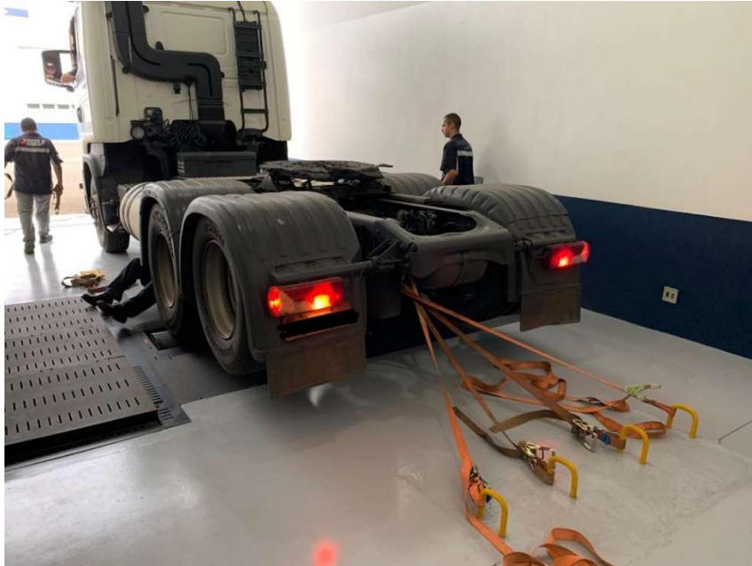
Figura 4 – Veículo 440hp, marca A ancorado para avaliação em dinamômetro de rolo em Pirassununga-SP.
