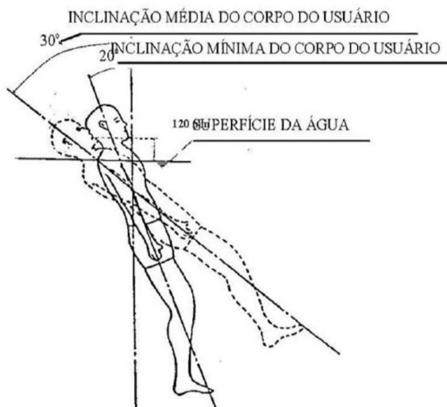
FIGURA 1 - Ângulo de inclinação do corpo do usuário do colete salva-vidas
