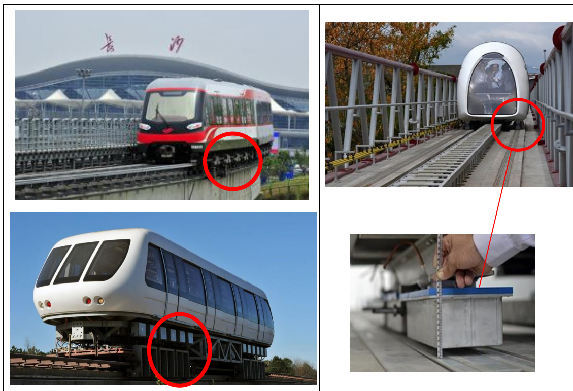
Figura 13. Comparação do sistema necessário para obter a levitação EML (lado esquerdo) com os criostatos necessários para o MagLev-Cobra, que emprega tecnologia SML (lado direito): mais simples e robusto
