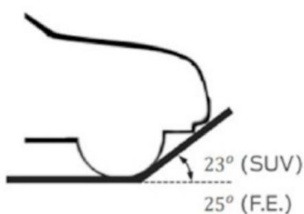
G.5 Para veículos das categorias utilitários esportivos e fora de estrada, a medição referentes ao ângulo de saída, deve ser realizada a partir do ponto tangencial posterior da área de contato do pneu até o ponto tangencial mais baixo da parte traseira em balanço do veículo, conforme apresentado na Figura 5. Não devem ser consideradas na medição as peças flexíveis (Exemplo: peças aerodinâmicas).
