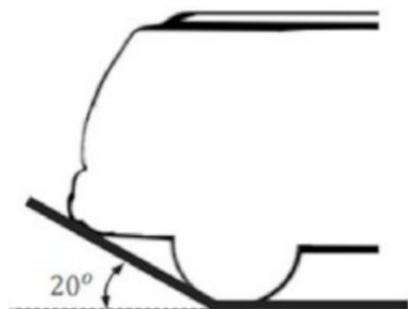
G.6 Para veículos das categorias D.2.6, D.2.7, D.2.8 e D.2.9, as medições referentes ao ângulo de transposição de rampa, devem ser efetuadas como a média dos ângulos a partir do ponto tangencial mais baixo entre os eixos do veículo até os pontos tangenciais posterior da área de contato do pneu do eixo dianteiro e anterior à área de contato do pneu do eixo traseiro, conforme figura 6.
