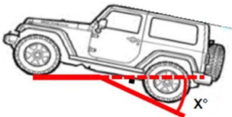
G.4 Para os veículos das categorias utilitários esportivos e fora de estrada, a medição referente ao ângulo de entrada deve ser efetuada a partir do ponto tangencial anterior da área de contato do pneu até o ponto tangencial mais baixo da parte dianteira em balanço do veículo, conforme apresentado na Figura 4. Não devem ser consideradas na medição as peças flexíveis (Exemplo: peças aerodinâmicas).
