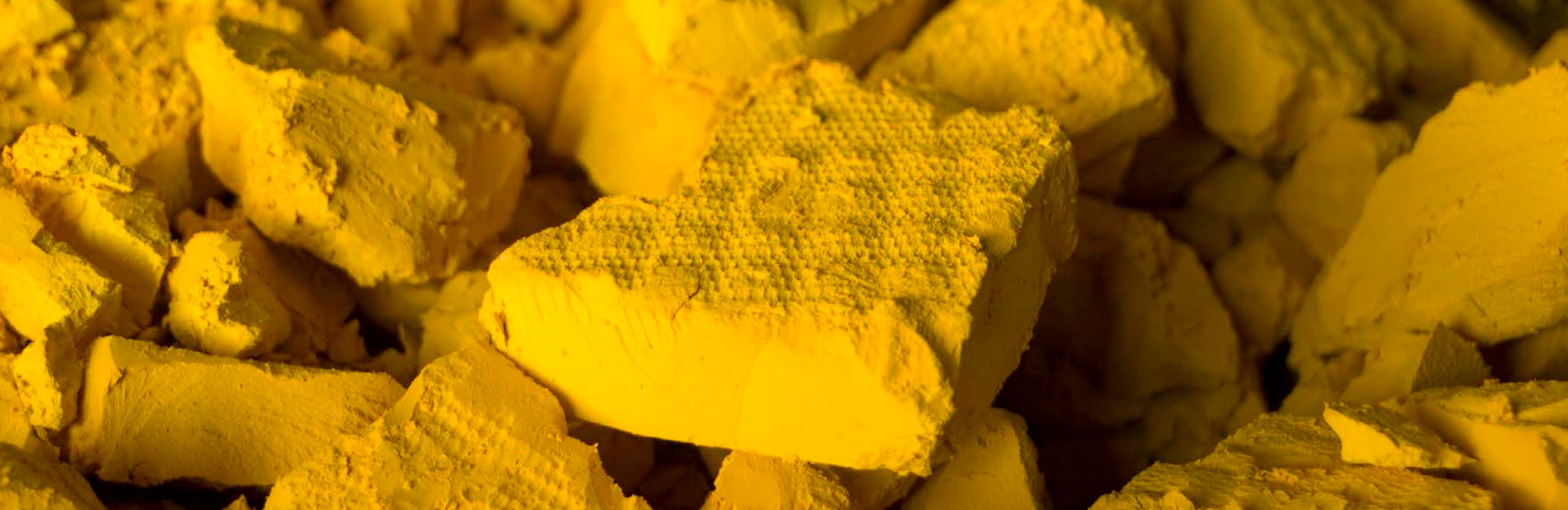
Yellowcake, etapa de processamento do minério de urânio antes da fabricação do combustível nuclear
